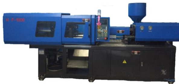
ภาพที่ 10 แสดงเครื่องฉีดพลาสติกรุ่น HYF-1000
