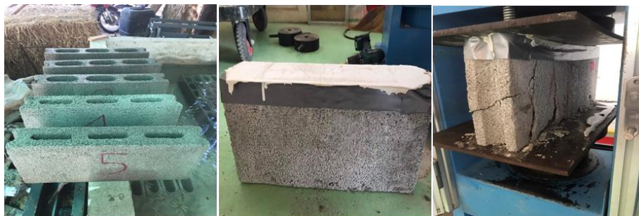
ภาพที่ 4 การทดสอบกำลังรับแรงอัดคอนกรีตบล็อกแทนที่หินปูนจากเปลือกหอยนางรมอบ
