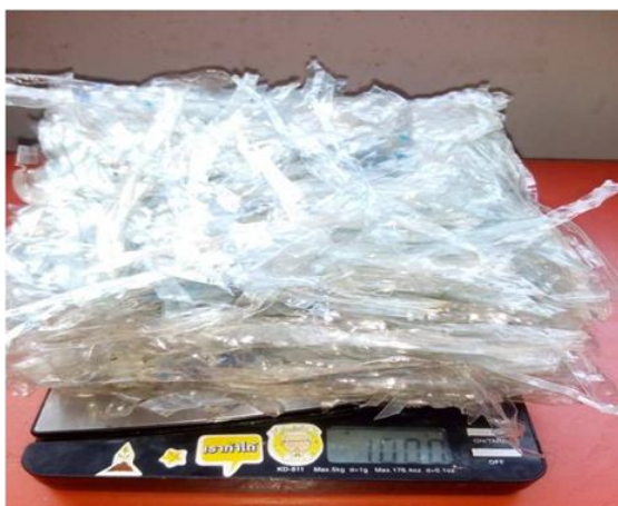
ภาพที่ 3 ชิ้นงานอัดก้อนขวดพลาสติกประเภท PET
