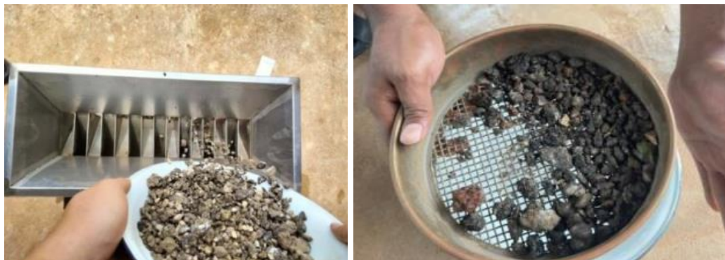
ภาพที่ 6 การเตรียมตัวอย่างแอสฟัลต์คอนกรีตเก่า (RAP)
