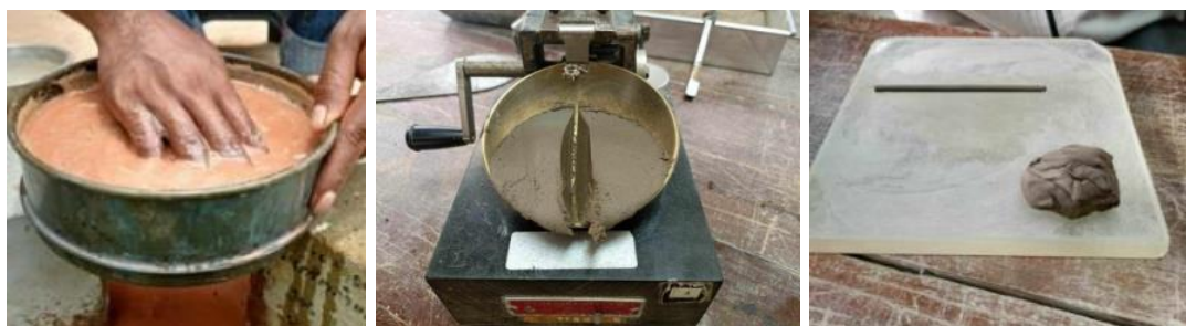
ภาพที่ 7 การทดสอบหาคุณสมบัติพื้นฐานทางวิศวกรรมของดินลูกรัง
