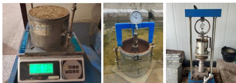
ภาพที่ 9 การทดลองหาค่า CBR แบบแช่น้ำ (Soaked)
