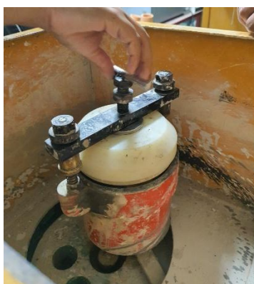
ภาพที่ 2 การบดผสมด้วยเครื่องบดผสมความเร็วสูง (Hi-speed mixer)
