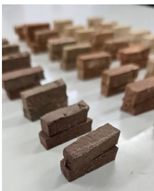
ภาพที่ 3 แท่งทดลองเนื้อสโตนแวร์จากส่วนผสมของดินบ้านทุ่งหลวง ดินชาวลำปาง และทรายระยอง
