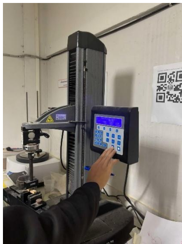
ภาพที่ 4 การทดสอบความแข็งแรงโดยใช้เทคนิค 3 Point bending test
