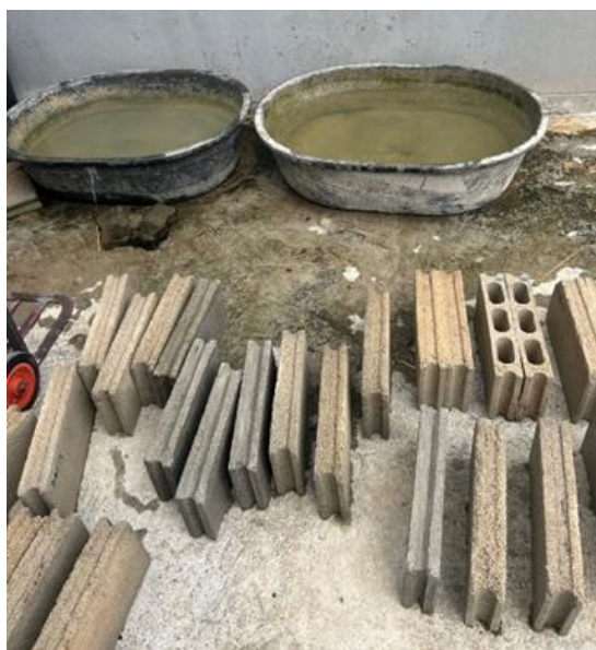
ภาพที่ 4 การทดสอบหาค่าการดูดซึมน้ำของอิฐบล็อก
