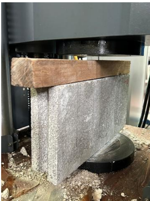
ภาพที่ 5 การทดสอบหาความต้านทานการอัดของอิฐบล็อก
