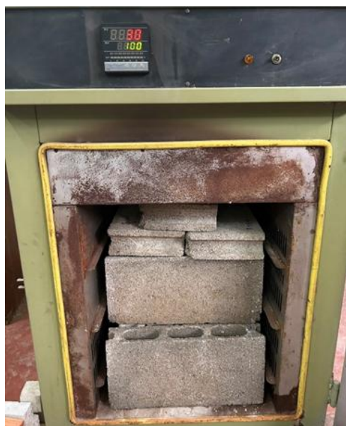
ภาพที่ 4 การทดสอบหาค่าการดูดซึมน้ำของอิฐบล็อก
