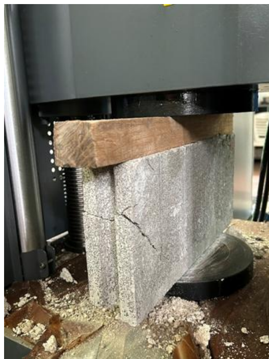
ภาพที่ 5 การทดสอบหาความต้านทานการอัดของอิฐบล็อก
