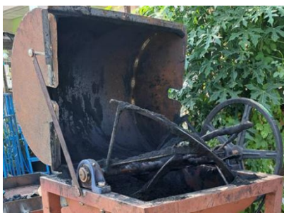
ภาพที่ 4.1 ฝุ่นผงเกาะติดบริเวณฝาครอบของเครื่องผสม
