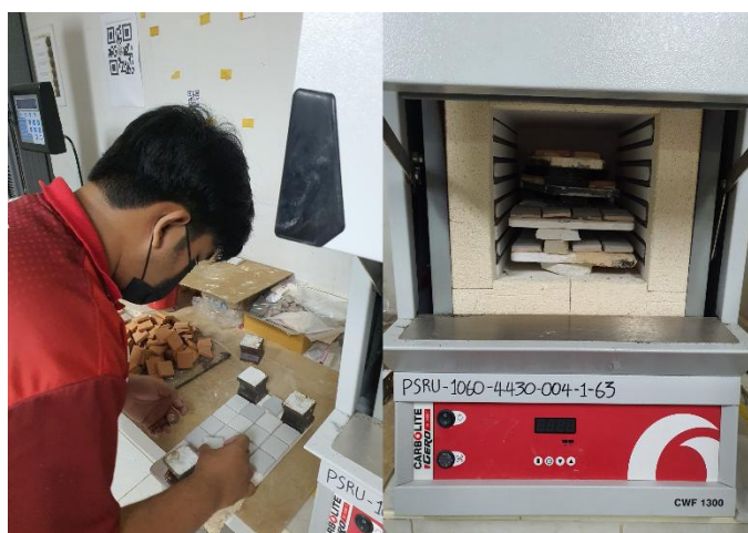
ภาพที่ 2 เผาแผ่นทดลองด้วยเตาเผาชนิดไฟฟ้า
