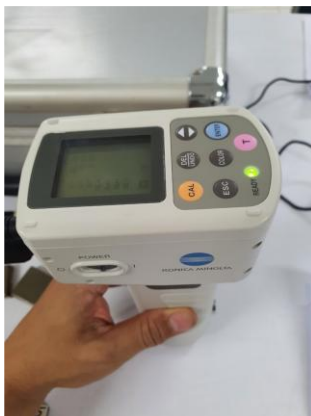
ภาพที่ 3 ทดสอบค่าสีและความสว่างของเคลือบด้วยเครื่อง Chroma Meter
