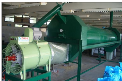
ภาพที่ 4 การสร้างและทดสอบเครื่องอบแห้งข้าวเปลือกแบบท่อหมุน
