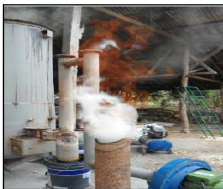
ภาพที่ 5 การสร้างและทดสอบเครื่องแก๊สซิไฟเออร์จากเชื้อเพลิง
