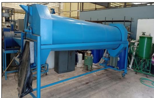
ภาพที่ 4 การสร้างและทดสอบเครื่องอบแห้งข้าวเปลือกแบบท่อหมุน
