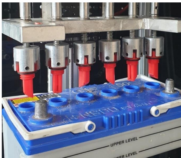
ภาพที่ 6 การทดสอบส่วนการจับฝาจากแบตเตอรี่และยกขึ้นในแนวแกนระยะ 50 มิลลิเมตร
