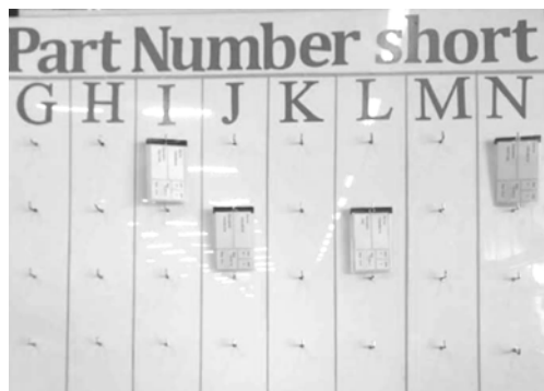
ภาพที่ 3 การนำบัตรคัมบังมาแขวนที่บอร์ด เพื่อรอให้พนักงานเติมนำวัสดุที่ขาดมาเติมตามรหัส
