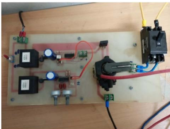
ภาพที่ 3 วงจรที่สมบูรณ์ของการผลิตฟิล์มบางด้วยเทคนิคสปาร์ค
