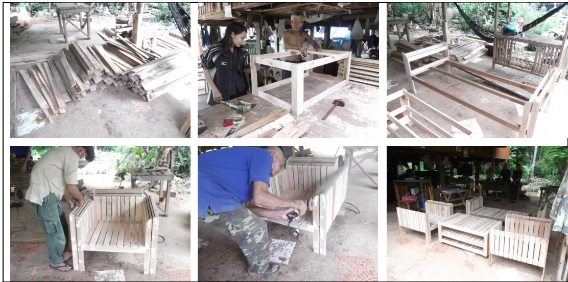
ภาพที่ 6 การผลิตต้นแบบเฟอร์นิเจอร์
