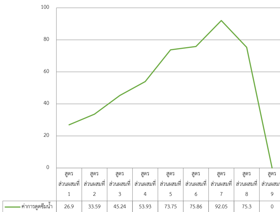
ภาพที่ 7 การดูดซึมน้ำของเนื้อดินปั้นภายหลังการเผา
