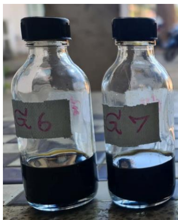
ภาพที่ 4 น้ำเชื้อเพลิงผสมที่เป็นไมโครอิมัลชัน
