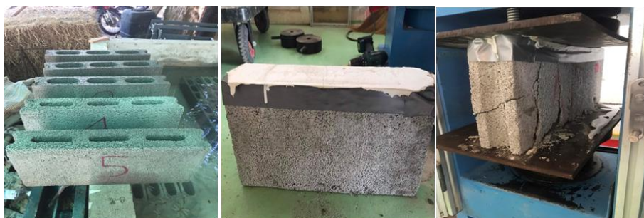
ภาพที่ 4 การทดสอบกำลังรับแรงอัดคอนกรีตบล็อกแทนที่หินปูนจากเปลือกหอยนางรมบด
