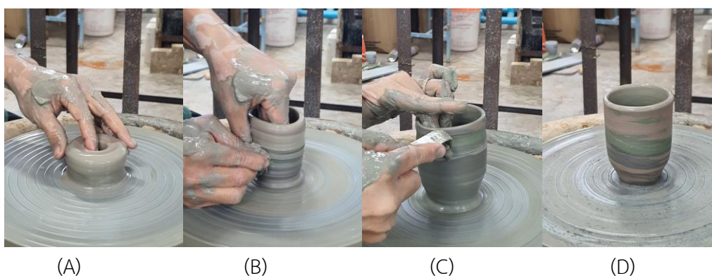
ภาพที่ 8 การขึ้นรูปด้วยแป้นหมุน (A) การตั้งศูนย์ (B) การรีดดึงดิน (C) การปรับแต่งผิวและการปรับรูปทรงของผลิตภัณฑ์ (D) การใช้ใบมีดขูดแต่งผิวผลิตภัณฑ์
