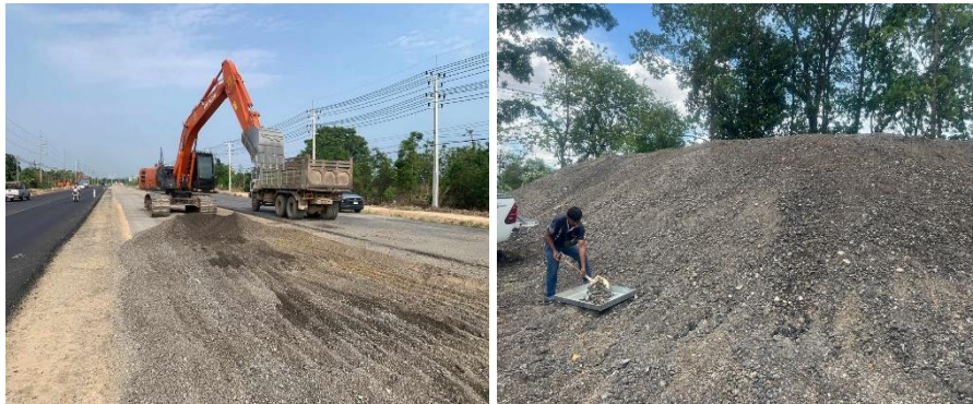
ภาพที่ 4 การเก็บตัวอย่างแอสฟัลต์คอนกรีตเก่า (RAP)
