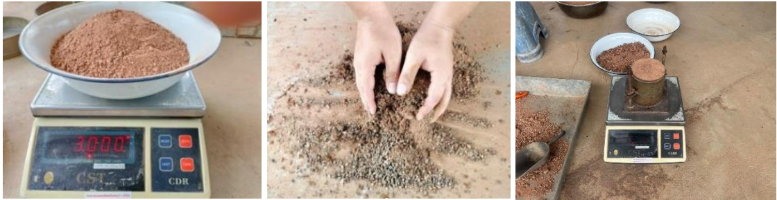
ภาพที่ 8 การทดสอบการบดอัดแบบสูงกว่ามาตรฐาน
