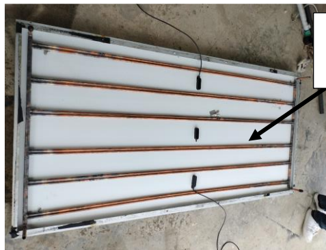
(c) ลักษณะของท่อทองแดงที่ได้ติดตั้งจริง
