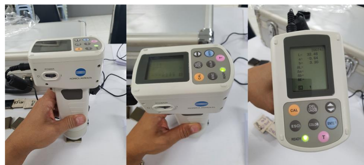
ภาพที่ 4 วัดค่าความสว่างและค่าสีด้วยเครื่อง Chroma meter
