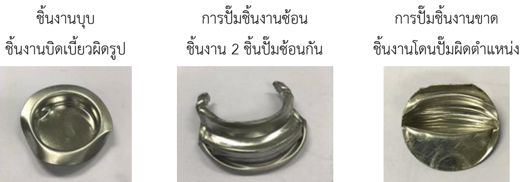
ภาพที่ 2 ลักษณะของเสียในขั้นตอนการตัดขอบและขั้นตอนการเจาะ
