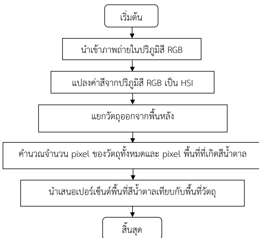
ภาพที่ 3 อัลกอริทึมการวิเคราะห์ภาพถ่ายสำหรับการหาปริมาณพื้นที่ที่เกิดสีน้ำตาล
