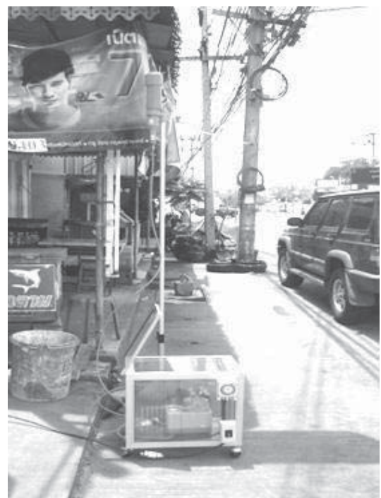
ภาพที่ 2 การติดตั้งอุปกรณ์เครื่องเก็บฝุ่นละออง ณ ถนนทะเลหลวง อำเภอเมือง จังหวัดสงขลา
