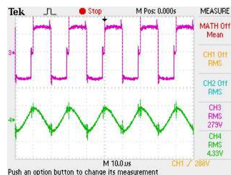
ภาพที่ 20 สัญญาณแรงดันและกระแสที่ออกจากเอาต์พุต 2 ที่ค่าวัฏจักรหน้าที่ 50 % ( V_o :200V/div, i_o :10V/div, Time:10 \mu s/div)
