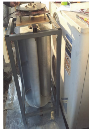
c) ทดสอบชุดกังหันกับลมร้อน เครื่องปรับอากาศ
