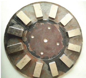
d) ชุดแม่เหล็กถาวรหล่อ เรซินติดติดจานหมุนจานหมุน
