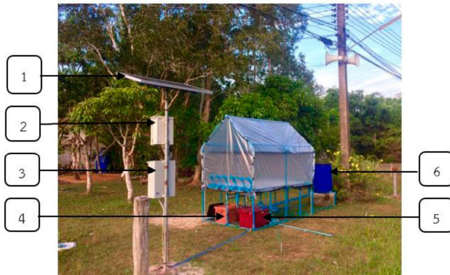
ภาพที่ 9 ลักษณะโครงสร้างของโรงเรือนแบบไฮโดรโปนิคส์ที่ใช้พลังงานแสงอาทิตย์
