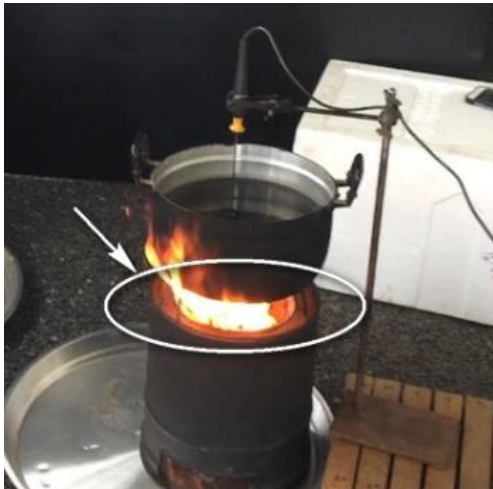
ภาพที่ 1 การสูญเสียพลังงานความร้อนของเตาชีวมวลชนิด TLUD ระดับครัวเรือนแบบเดิม
