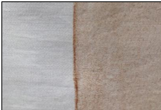
ภาพที่ 7 การพิมพ์ซิลค์สกรีนสีดินแดงที่ไม่มี ความคมชัดของลวดลาย
