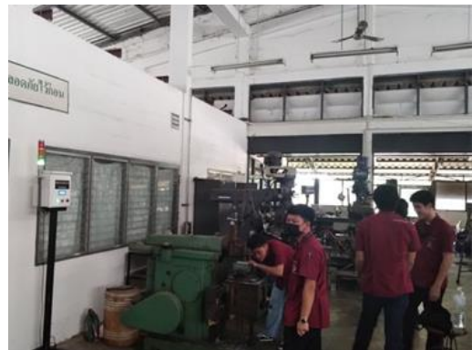
ภาพที่ 11 การติดตั้งเครื่องวัดฝุ่นในโรงฝึกปฏิบัติการ
