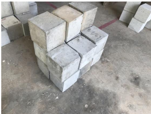
ภาพที่ 2 แท่งคอนกรีตชิ้นงานทดสอบ (Specimen)
