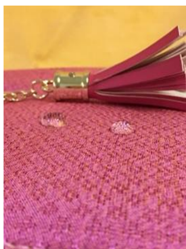
ภาพที่ 13 ผลิตภัณฑ์ต้นแบบผ้าไหมทอมือที่มีสมบัติสะท้อนน้ำ
