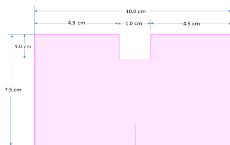
ภาพที่ 1 ขนาดชิ้นทดสอบในการทดสอบแรงฉีกขาด
