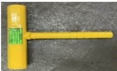
ภาพที่ 12 JIG ที่ใช้ตรวจสอบระยะความกว้างของ ช่องงานเสริมชิ้นด้านหัวของชิ้นงาน
