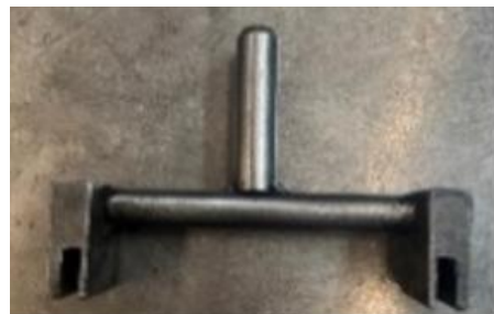
ภาพที่ 13 JIG ที่ใช้ตรวจสอบระยะความกว้างของ ช่องงานเสริมชิ้นด้านท้ายของชิ้นงาน
