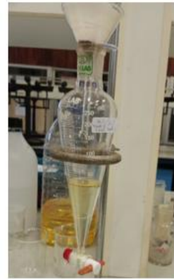
(ภาพที่ 3) การติดตั้งอุปกรณ์สำหรับการทำปฏิกิริยาเอสเทอร์ฟิเคชัน สารผสมของปฏิกิริยาภายหลังจากการเติมแอมเบอร์ลิสต์ 15 และการตั้งสารผสมของปฏิกิริยาในกรวยแยก
