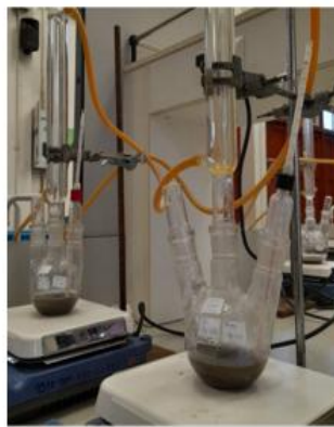
(ภาพที่ 3) การติดตั้งอุปกรณ์สำหรับการทำปฏิกิริยาเอสเทอร์ฟิเคชัน สารผสมของปฏิกิริยาภายหลังจากการเติมแอมเบอร์ลิสต์ 15 และการตั้งสารผสมของปฏิกิริยาในกรวยแยก
