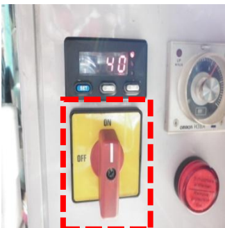
ภาพที่ 18 แสดงการหมุนสวิตช์เพื่อเริ่มการทำงาน ของเครื่องทำน้ำข้าวกล้องงอกกึ่งอัตโนมัติ
