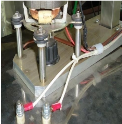
ภาพที่ 9 แสดงตัวยึดฉาถัง และมอเตอร์กับเสาคว่ำ
