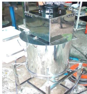
ภาพที่ 16 แสดงเครื่องทำน้ำข้าวกล้องงอกกึ่งอัตโนมัติที่พัฒนาขึ้นเมื่อเสร็จสมบูรณ์
