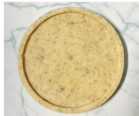
ภาพที่ 6 แผ่นรองแก้วยางพาราเสริมแรงด้วยเส้นใย
