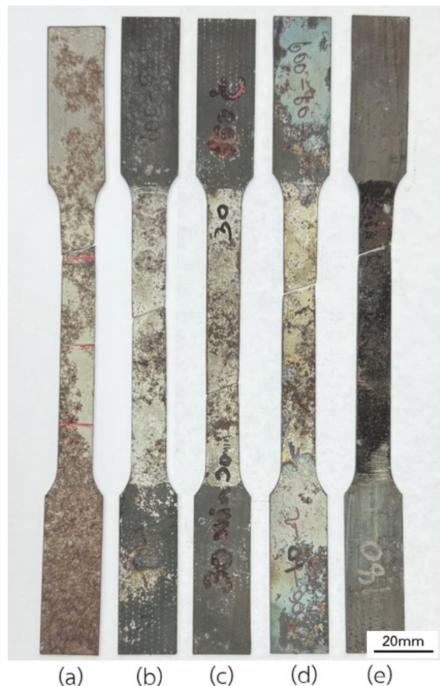
ภาพที่ 6 ลักษณะชิ้นทดสอบแรงดึง (a) ไม่ผ่านการอบอ่อน (b) อบอ่อน 5 นาที (c) อบอ่อน 30 นาที (d) อบอ่อน 60 นาที และ (e) อบอ่อน 180 นาที
