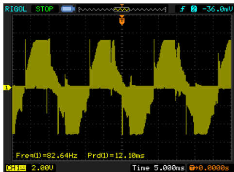
ภาพที่ 14 สัญญาณ UV ที่ขั้วมอเตอร์ BLDC ที่ความเร็ว 150 rpm
