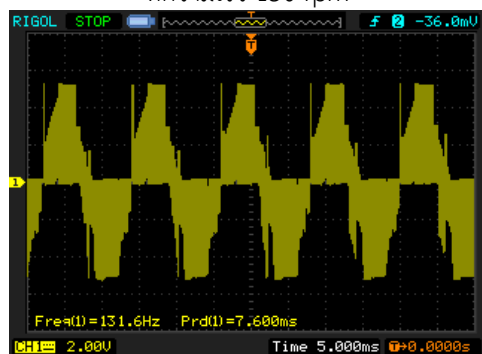
ภาพที่ 15 สัญญาณ UV ที่ขั้วมอเตอร์ BLDC ที่ความเร็ว 200 rpm
