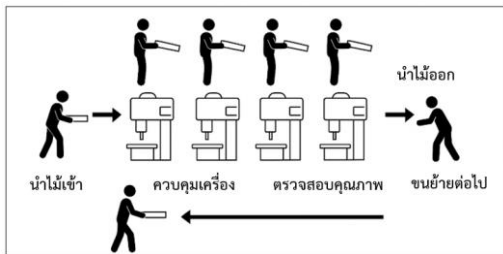
ภาพที่ 1 แสดงผังการจัดวางพื้นที่การทำงานของเครื่องตีก๊อปปี๋ก่อนการปรับปรุง
