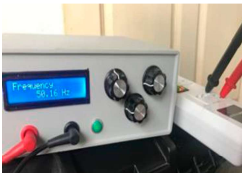
ภาพที่ 7 เครื่องต้นแบบวัดค่าทางไฟฟ้าแสดงหน้าจอขณะกำลังใช้งานวัดค่าความถี่ไฟฟ้า
