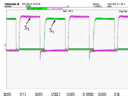
ภาพที่ 8 สัญญาณขับเคลื่อนของสวิตช์ S_1 และ S_3 ในวงจรอินเวอร์เตอร์ ที่มาจากไอซี IR2110 ตัวที่ 1
