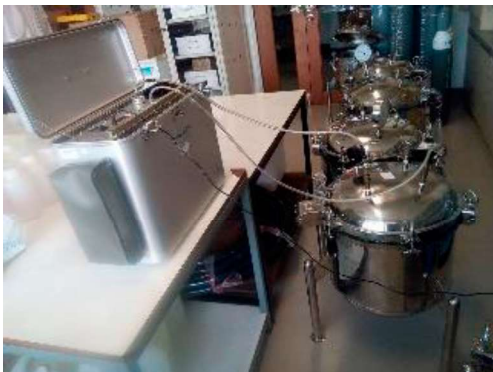
ภาพที่ 2 การวัดความเข้มข้นของแก๊สเรดอนในวัสดุก่อสร้างด้วยเครื่อง ATMOS 12 dpx [8]
