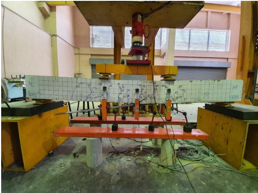
ภาพที่ 13 คาน SB-1S-4mm เมื่อหยุดให้น้ำหนักบรรทุกกระทำ
