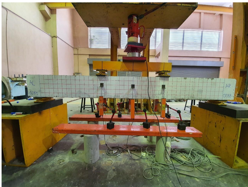
ภาพที่ 12 คาน SB-1S-4mm ก่อนให้น้ำหนักบรรทุกทุกกระทำ
