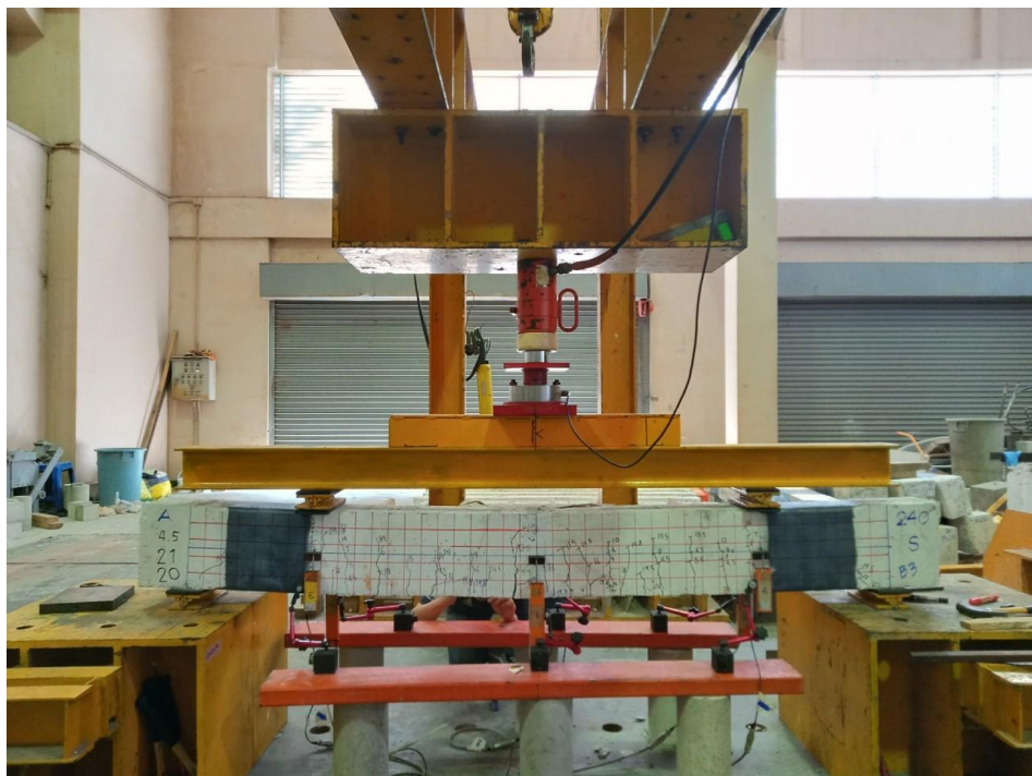
ภาพที่ 17 คานเสริมกำลัง SB-1S-1.5h เมื่อหยุดให้น้ำหนักบรรทุกทุกกระทำ
