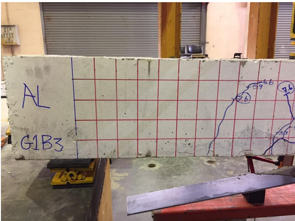
ภาพที่ 21 การหลุดล่อนที่ปลายแผ่นเหล็กของคานเสริมกำลัง SB-1S-4mm
