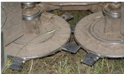
ภาพที่ 6 การติดตั้งใบมีดในรถตัดอ้อย
