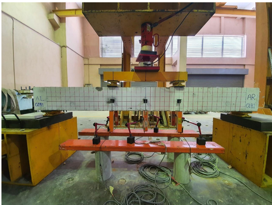
ภาพที่ 10 คาน CB-1S ก่อนให้น้ำหนักบรรทุกกระทำ
