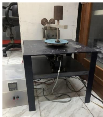
ภาพที่ 4 เครื่องทดสอบการสึกหรอ ชนิด Pin-on-disc
