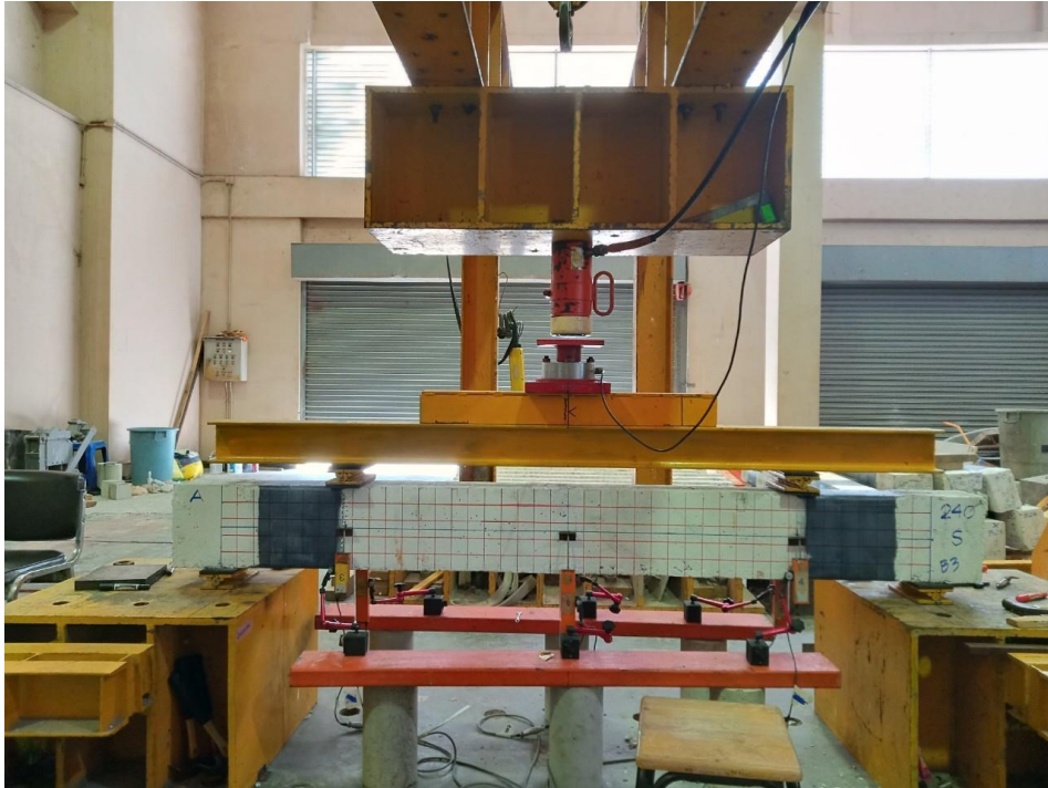
ภาพที่ 16 คานเสริมกำลัง SB-1S-1.5h ก่อนให้น้ำหนักบรรทุกทุกกระทำ
