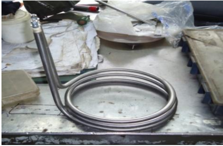
ภาพที่ 13 แสดงฮีตเตอร์ที่จะทำการติดตั้ง
