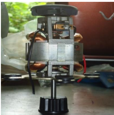
ภาพที่ 10 แสดงมอเตอร์ไฟฟ้า 1 เฟสขนาด 700 วัตต์
