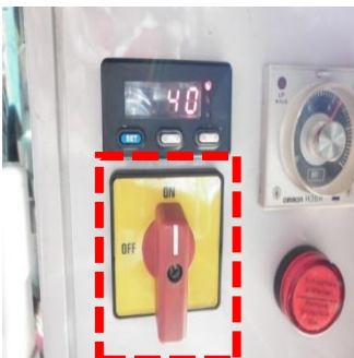
ภาพที่ 18 แสดงการหมุนสวิทช์เพื่อเริ่มการทำงาน ของเครื่องทำน้ำข้าวกล้องงอกกึ่งอัตโนมัติ
