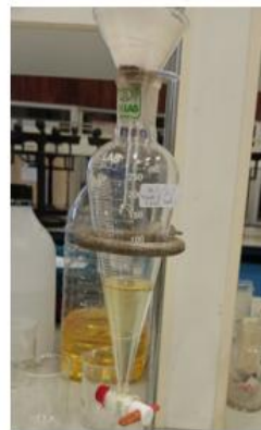
(ภาพที่ 3) การติดตั้งอุปกรณ์สำหรับการทำปฏิกิริยาเอสเทอร์ฟิเคชัน สารผสมของปฏิกิริยาภายหลังจากการเติมแอมเบอร์ลิสต์ 15 และการตั้งสารผสมของปฏิกิริยาในกรวยแยก
