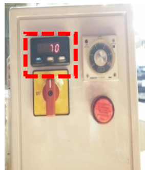
ภาพที่ 19 แสดงเครื่องทำน้ำข้าวกล้องงอก กึ่งอัตโนมัติทำงานอุณหภูมิถึง 70 องศาเซลเซียส
