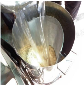
ภาพที่ 17 แสดงการใส่วัตถุดิบลงในเครื่องทำน้ำข้าว กล้องงอกกึ่งอัตโนมัติ
