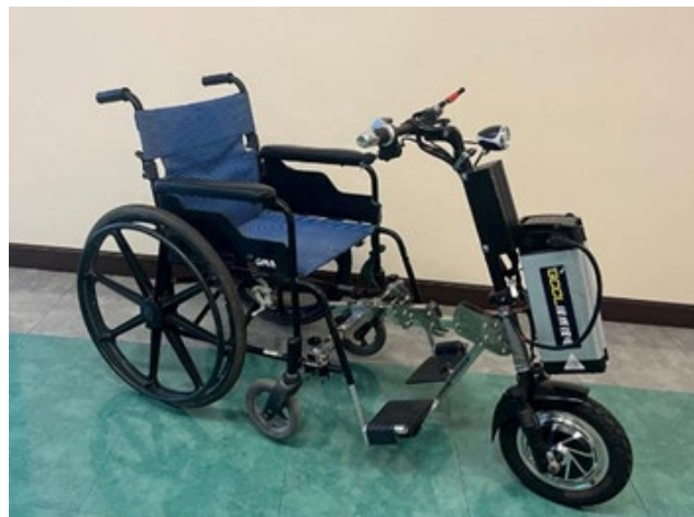
ภาพที่ 4 แสดงส่วนประกอบชุดหัวลากไฟฟ้าสำหรับรถเข็นคนพิการ
