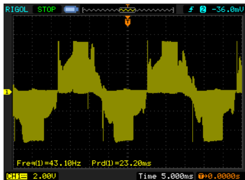
ภาพที่ 13 สัญญาณ UV ที่ขั้วมอเตอร์ BLDC ที่ความเร็ว 100 rpm
