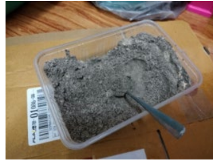
ภาพที่ 2 แสดงการผสมระหว่าง กากกาแฟกับกาบ
