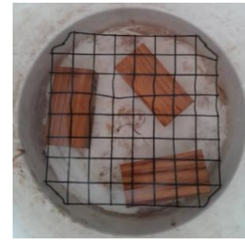
ภาพที่ 17 ตัวอย่างชิ้นไม้ทดสอบแช่น้ำอุณหภูมิอยู่ที่ 23\pm 2 °C.
