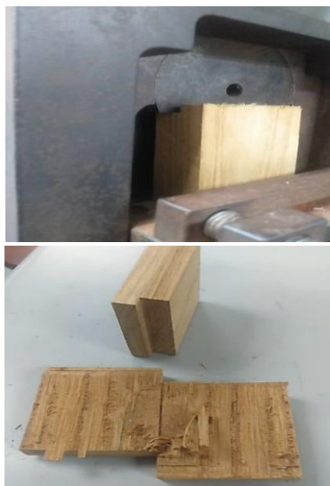
ภาพที่ 11 การเสียรูปหลังจากทดสอบแรงเฉือน (Shear tests)
