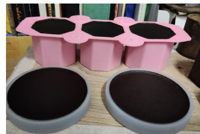
ภาพที่ 4 แสดงการอัดเป็นผลิตภัณฑ์ด้วยแบบแม่พิมพ์
