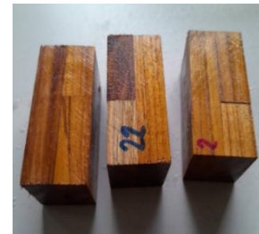
ภาพที่ 18 ลักษณะชิ้นไม้สักรวนป่าหลังจากทดสอบการติดของกาว
