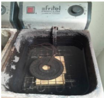
ภาพที่ 16 ตัวอย่างชิ้นไม้ทดสอบต้มในน้ำร้อน อุณหภูมิอยู่ที่ 100\pm 3 °C.
