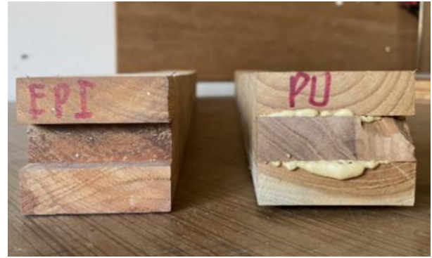
ภาพที่ 7 Glued Laminated Timber (Glulam) จากเศษไม้สักสวนป่า ที่ใช้กาวโพลียูรีเทน (PU) และกาวอีพ็อกซีโพลีเมอร์ไอโซไซยาเนต (EPI)
