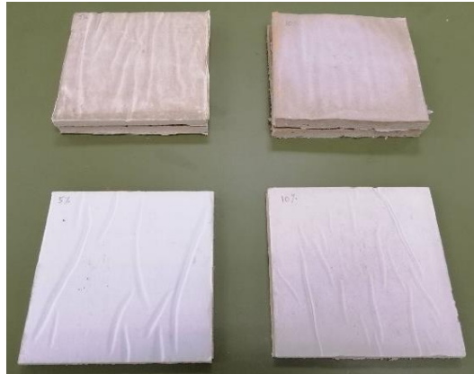
ภาพประกอบ 2 แผ่นฝ้าเพดานจากใยไม้ผสมผงยิปซัม
