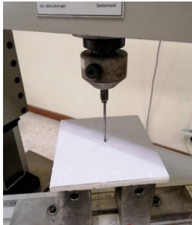
ภาพประกอบ 5 การทดสอบแรงต้านการดึงตะปูของแผ่นฝ้าเพดานจากใยไม้ผสมผงยิปซัม
