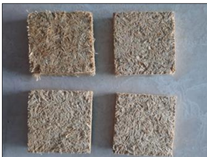
ภาพประกอบ 2 (ซ้าย) ตัวอย่างชิ้นทดสอบแผ่นขึ้นไม้อัดด้านทานการลามไฟจากเปลือกข้าวโพดเคลือบเจลาตินปลาที่อัตราส่วนของเจลาตินปลาต่อน้ำ 40:100 g/cm 3 และ(ขวา) การติดตั้งเครื่องทดสอบแบบ HB Test (ศูนย์เทคโนโลยีโลหะและวัสดุแห่งชาติ, 2549)
