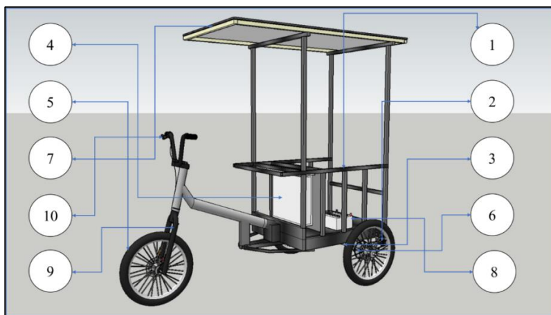
ภาพประกอบ 2 แบบจำลอง 3 มิติรูปทรงของรถสามล้อไฟฟ้าด้วยมอเตอร์ไร้แปรงถ่าน
