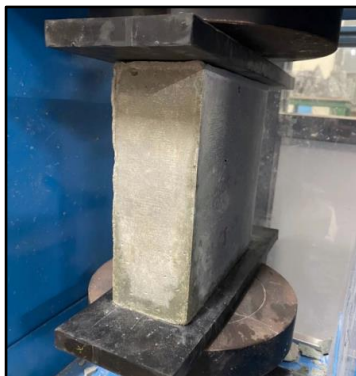
ภาพประกอบ 3 การทดสอบกำลังอัดของอิฐมวลเบา
