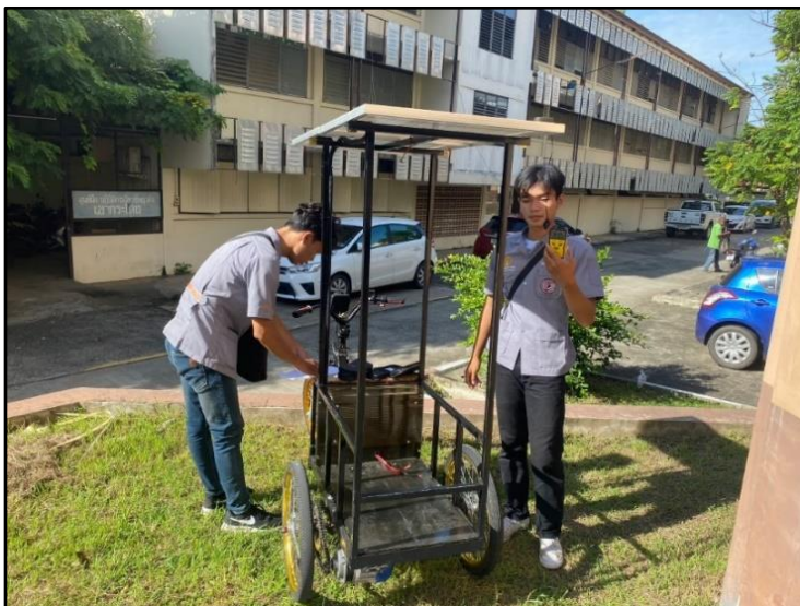
ภาพประกอบ 12 ทดสอบวัดค่าของแผงโซลาร์เซลล์โดยใช้แสงจากดวงอาทิตย์
