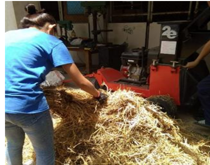
ภาพที่ 2 สับฟางข้าวโดยใช้เครื่องบดเนกประสงค์
