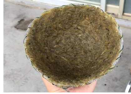
ภาพที่ 6 เคลือบบรรจุภัณฑ์ด้วยสารละลายผงบุก
