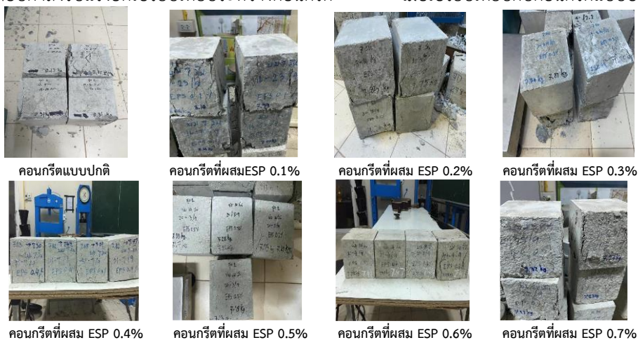
ภาพที่ 4 การเปรียบเทียบความเสียหายของตัวอย่างคอนกรีตแบบปกติกับคอนกรีตที่ผสมอีพีเอสโม่
