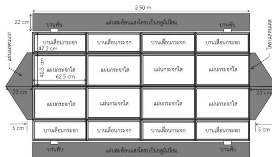
ภาพที่ 2 ภาพร่างด้านบนพร้อมข้อมูลขนาดของตู้ตากพลาสติก
