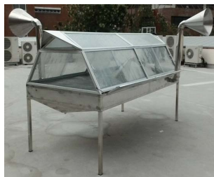
ภาพที่ 5 ตู้อบแห้งพลาสติกที่ดำเนินการสร้างตามแบบ
