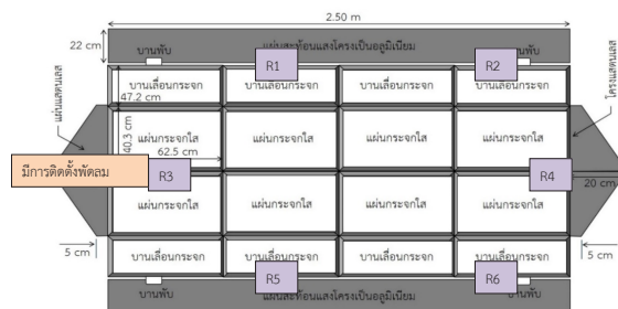
ภาพที่ 7 ตำแหน่งการติดตั้งตัวรับรู้อุณหภูมิและความชื้นสัมพัทธ์ (DHT22 Sensor)
