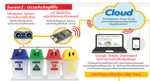
ภาพที่ 6 Sensor 2 ตรวจจับวัตถุที่ทิ้ง
