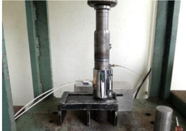
ภาพที่ 2 บล็อกทรงกระบอกพร้อมฮีตเตอร์ความยาว 10 เซนติเมตร
