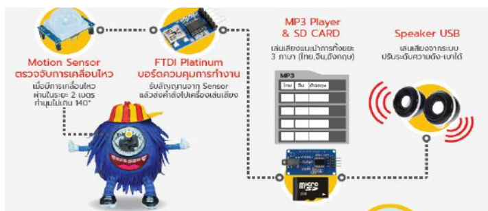
ภาพที่ 4 Sensor ตรวจจับคนมาขึ้นหน้าถัง
