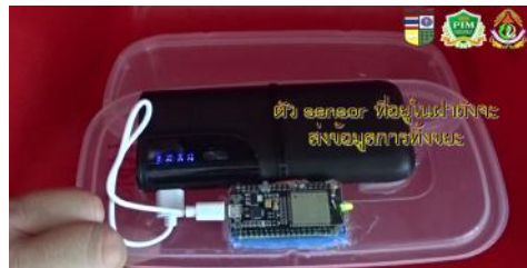
ภาพที่ 11 ตัวอุปกรณ์ sensor ที่ส่งข้อมูลสถิติการทิ้งขยะผ่านระบบอินเทอร์เน็ต
