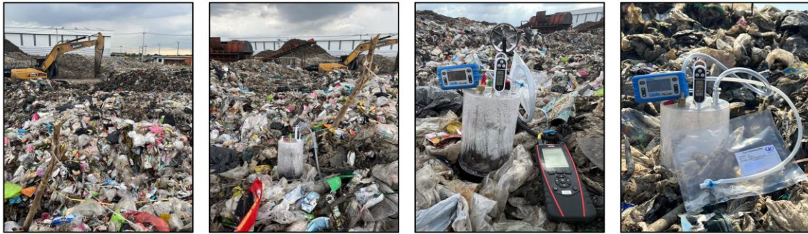
ภาพที่ 3 การเก็บตัวอย่าง VOCs ด้วยวิธี Surface Emission Isolation Fluxes Chamber
